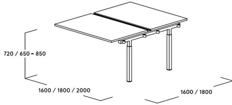
Bench Twin Baukasten – Endmodul
